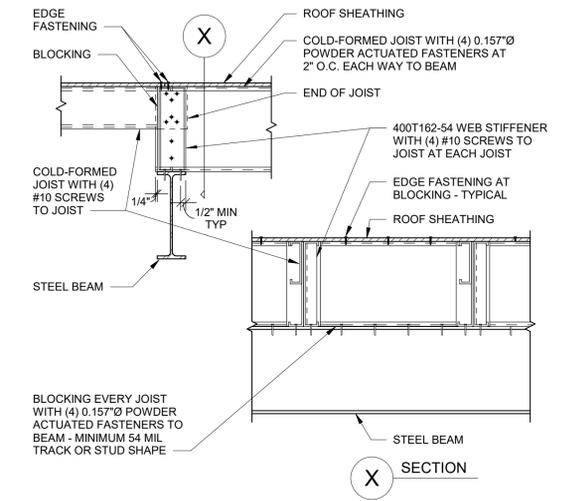
**202 COLD-FORMED JOIST AT STEEL BEAM**
