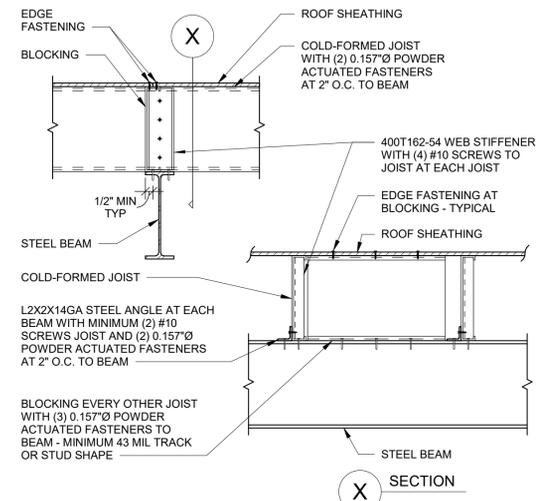
**205 COLD-FORMED JOIST AT STEEL BEAM**
