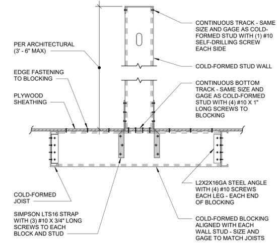
**209 COLD-FORMED PARAPET WALL AT BLOCKING BETWEEN JOISTS**
