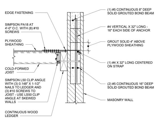
**212 COLD-FORMED JOIST AT MASONRY WALL**
