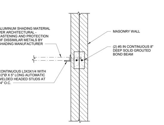
**211 STEEL LEDGER AT MASONRY WALL**
