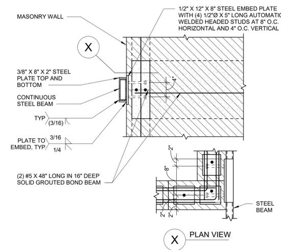
**208 STEEL BEAM AT MASONRY WALL**
