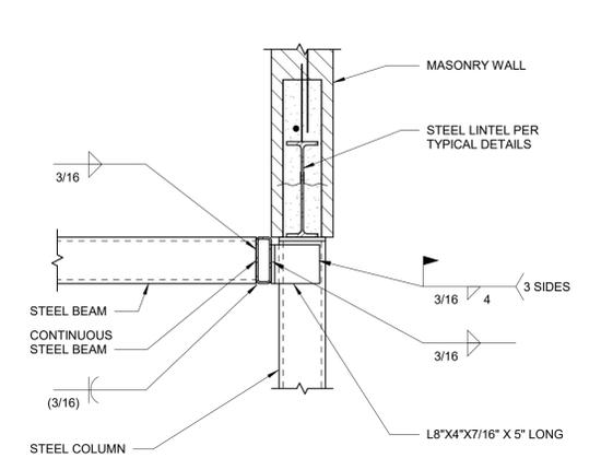
**207 STEEL BEAM AT STEEL LINTEL**
