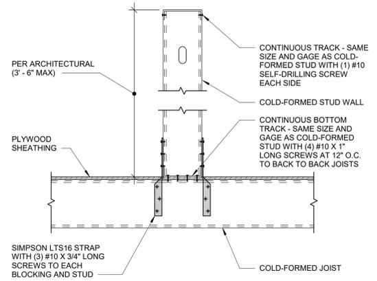
**210 COLD-FORMED PARAPET WALL AT JOISTS**
